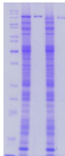
図 1. SDS-PAGEの例。M: 分子量マーカー、1: コムギ胚芽抽出液中でRNAリガーゼタンパク質を合成させた試料、2: 精製したRNAリガーゼ、3, 4: RNase Rタンパク質について1,2と同様に行った試料。
